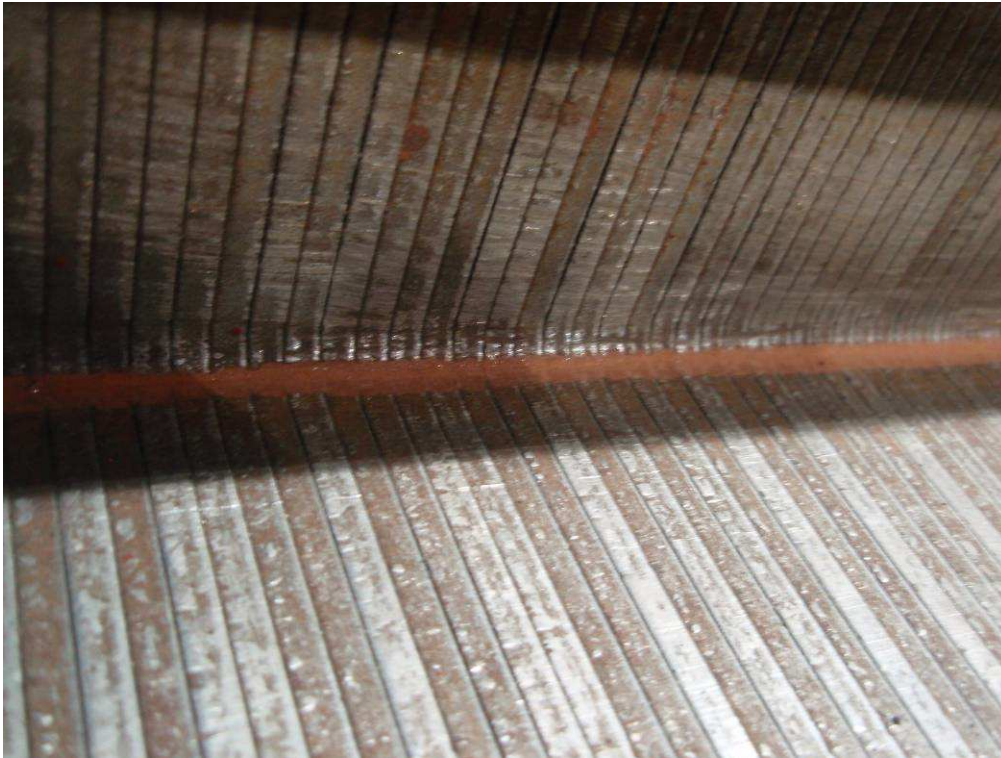
Bild 4: nicht zulässige Farbreste im zu prüfenden Radius
